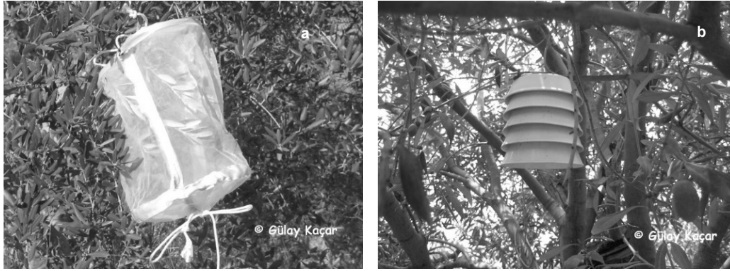
Şekil 1. Palpita unionalis (Hüb.)'in biyolojik çalışmalarında kullanılan dal kafesleri (a) ve Hobo cihazı (b)
