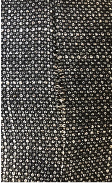
Şekil 2. Seyrek yapı ve uzun atlamalı desenleri olan dokuma kumaşlardaki dikiş kayması sonucu görüntü bozukluğu
