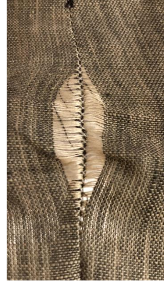
Şekil 3. Atkı ve çözgü ipliği zıt renkte dokunmuş kumaşlardaki dikiş kayması sonucu görüntü bozukluğu
