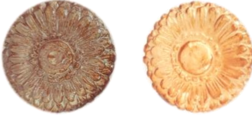
Resim 3: Kırmızı (Sol) ve Beyaz Pekişmiş (Sağ) Çamur Bünyeli Deney Plakaları Üzerine Fırın Kapağı Açılarak Demir (III) Klorürün Sulu Karışımı Püskürtülmüştür
