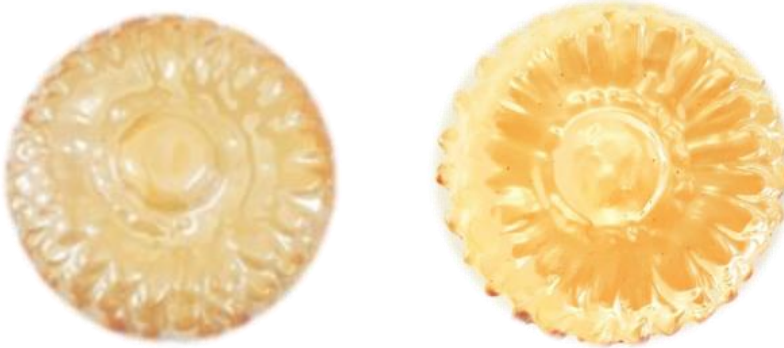
Resim 4: %3 Kalay Oksit İçeren Zemin Sırı (Sol) ve Duncan Opak (Sağ) ( Kod: IN 1100 ) Sır İle Sırlanmış Plakalar Üzerine Demir (III) Klorür Püskürtülmüştür
