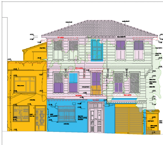
Kirazlı Mescit Sokağı Görünüşü "HASAR TESPİTİ"
