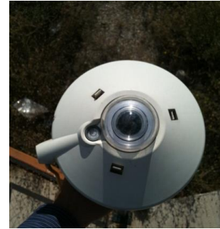
Şekil 1. Güneş ışınımı ölçümlerinin yapıldığı Kipp&Zonen marka pironometre
