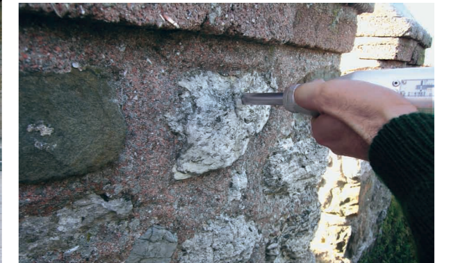
F.7: Örnek alma imkanı olmayan yerlerde basınc dayanımının tespiti için, Schmidt Çekici ile rebound (geritepki) değeri ölçülebilir. (KUDEB Rest. ve Kons. Lab., 2007).
