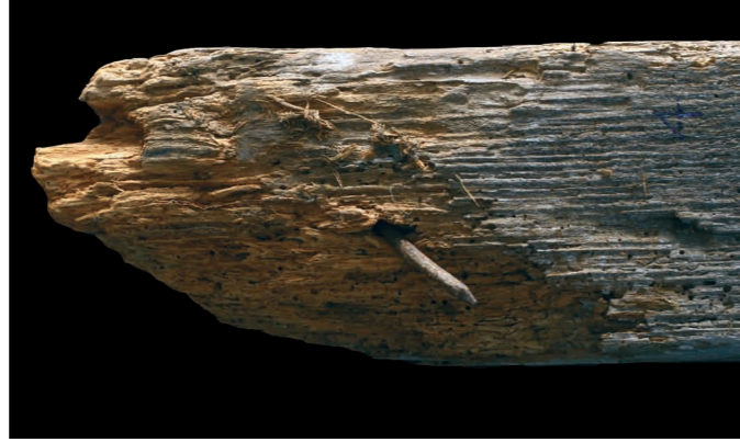
F.13: Organizma faaliyetine bağlı olarak, ahşapta görülen bozulmalar ve kesit kaybı (KUDEB Rest. ve Kons. Lab., 2008)
