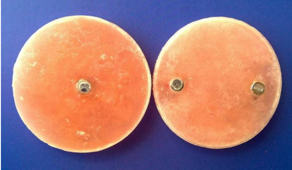
Resim 1. Tek ve çift düzende akrilik rezine gömülmüş mıknatıslar
