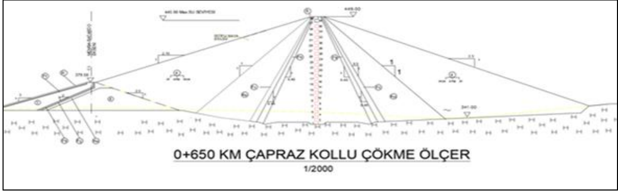
Şekil 7. Baraj gövdesinde bulunan çapraz kollu çökme ölçerler (0+650 km) (Magnetic ekstensometer in dam body)
