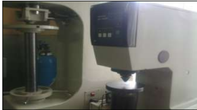
Şekil 5. Atas marka sertlik ölçüm cihazı (Hardness tester)
