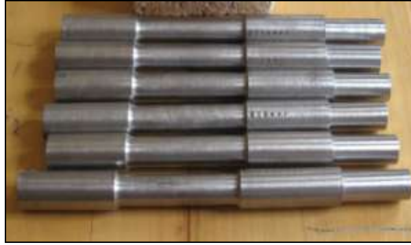
Şekil 4. TS 138A'ya göre işlenmiş çekme test numuneleri (According to TS 138A tensile test samples)
