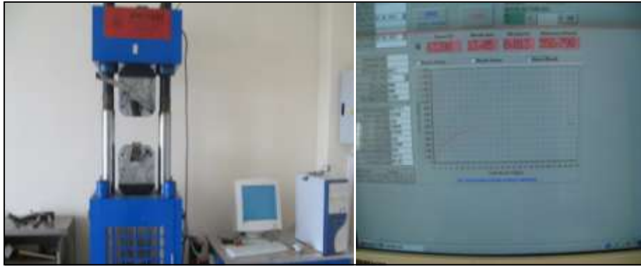
Şekil 7. Atom teknik marka 50 ton kapasiteli çekme cihazı (Tensile tester)
