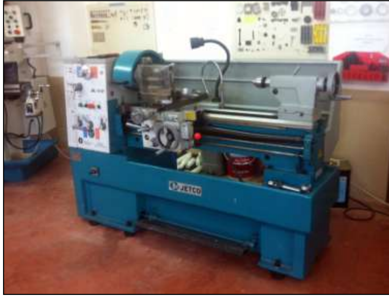
Şekil 2. Deneysel çalışmada kullanılan JETCO JML-4110Y marka konvansiyonel torna tezgahı (Conventional Lathe)
