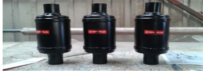
Şekil 8. Boyama işlemi sonrasında elde edilen konvertörler.
