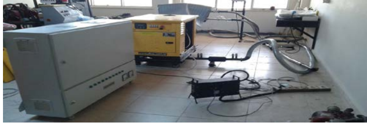
Şekil 9. Hazırlanan konvertörlerin dizel motor ünitesine bağlanması.
