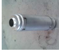
Şekil 7. Filtre malzemesi doldurulan konvertörün iki ucunun kapakla kapatılması.
