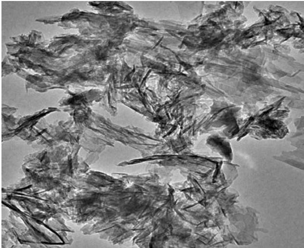
Şekil 6. 180 °C; 8 sa.; Ca/Si:0,83 reaksiyon koşullarında sentezlenen kalsiyum silikat örneğinin TEM görüntüleri.
