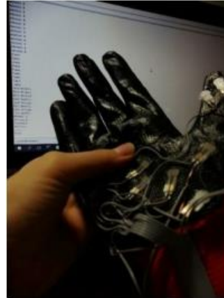
Resim 10, 11: Eldiven Üzerinde Endokrin Refleks Noktalarına Basınç Sensörlerinin Yerleştirilmesi
