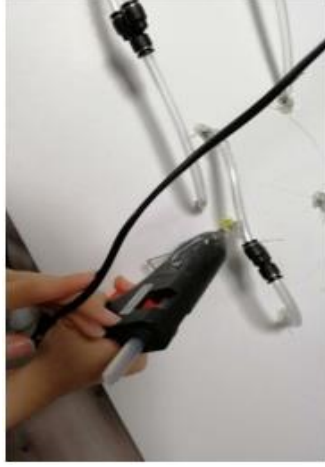
Resim 9: Suyun akış yönlerinin belirlenmesi ve belirlenen yerlere LED döşenip silikonlanması
