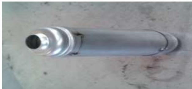
Şekil 8. Filtre malzemesi doldurulan konvertörün iki ucunun kapakla kapatılması
