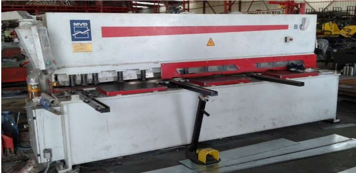
Şekil 3. MVD marka hidrolik giyotin makas
