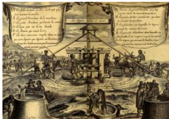
Şekil 7. Şeker Yeni Dünya’da, Antiller’de Hayvan Gücüyle Çalışan Üç Dikey Silindirli Değirmen Tasviri, 1665, (Rochefort, 1665: 332).
