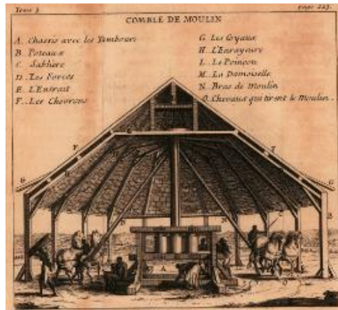
Şekil 10. Martinique Adası, 17. Yüzyıla Ait (Needham, Daniels, & Menzi, 2010 (6/3): 334) Bir Şeker Değirmeninin ("Comble De Moulin") Kesiti; Dikey Silindirler (A), Ahşap Direk (B), Atların Sürüldüğü Kumluk Alan (C), Çatı Makası (D), Çatı Makas Kirişlerinin Ve Çatı Direğinin Bir Araya Getirildiği Üçgen Dayanak (E), Çatı Merteği (F), Çatının Eğimini Yumuşatmak İçin Eklenen İskelet Parçası (G), Bağlayıcı Çatı Elemanı (H), Değirmen Kolları (N), Ahşap Direğin Tepesindeki Sabitleyici Parça (M), Değirmeni Çeken Atlar (O), (Labat, 1722/3: 223).
