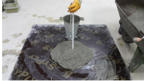
Şekil 13. S4 kıvam sınıfının kontrolü için çökme deneyinin uygulanışı
