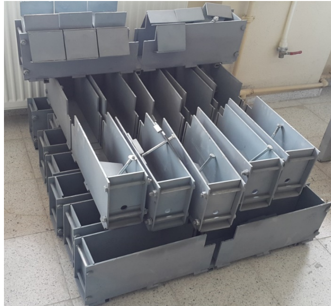
Şekil 10. Mafsallı kirişlerin üretimi için yaptırılan özel kalıplar
