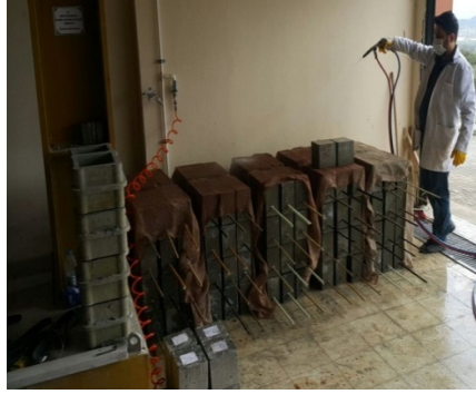
Şekil 21. Üretilen mafsallı kirişlere ıslak çuvallarla kür uygulanması
