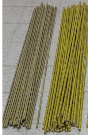
Şekil 9. Deneysel çalışmada kullanılan kumlanmış (sol) ve helisel sargılı (sađ) aramid lifli kompozit donatılar
