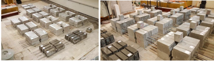
Şekil 22. Üretilen ve deneye hazır hale getirilen mafsallı kiriş örnekleri
