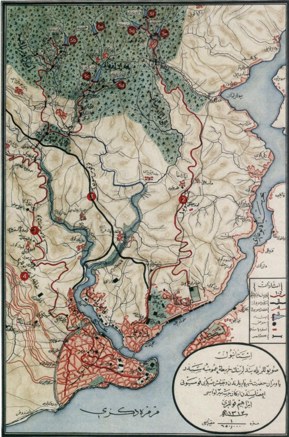
Şekil 1. Sultan II. Abdülhamit Dönemi'nde Mirliva İbrahim Edhem Paşa ve oğlu Üsteğmen Nureddin Bey tarafından çizilen İstanbul'un suyolları ve bendlerinin haritaları [7] (1-Kırkçeşme Su Yolu, 2-Taksim Su Yolu, 3-Terkos Su Yolu, 4-Halkalı Su Yolu, 5-a)Topuz Bent, b)Ayvad Bendi, c)Büyük Bent, d)Kirazlı Bent, e)Topuzlu Bent, f)Valide Bendi, g)II.Mahmut Bendi)
