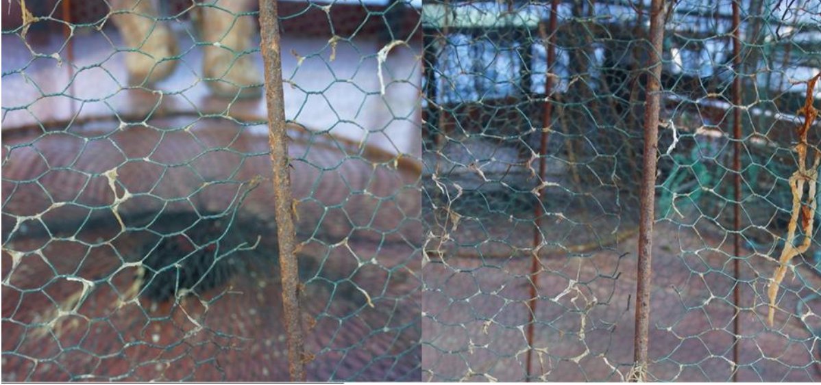
Şekil 4. Tel tuzaklarda meydana gelen deformasyonlar
