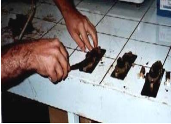
Şekil 4. Asfalt çimentosunun kalıba konması (Putting of asphalt cement into the formwork)
