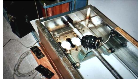
Şekil 2. Duktulite cihazı ve numuneler (Machine of ductulity and samples)
