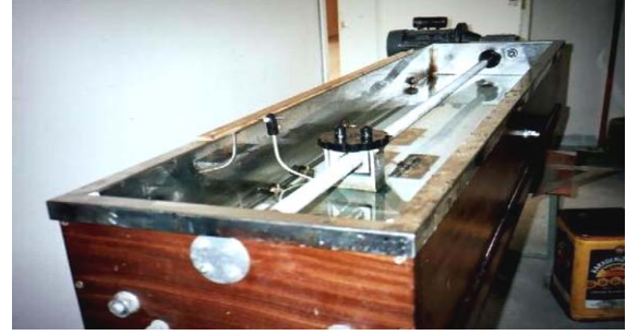
Şekil 1. Duktulite cihazı (Machine of ductulity)
