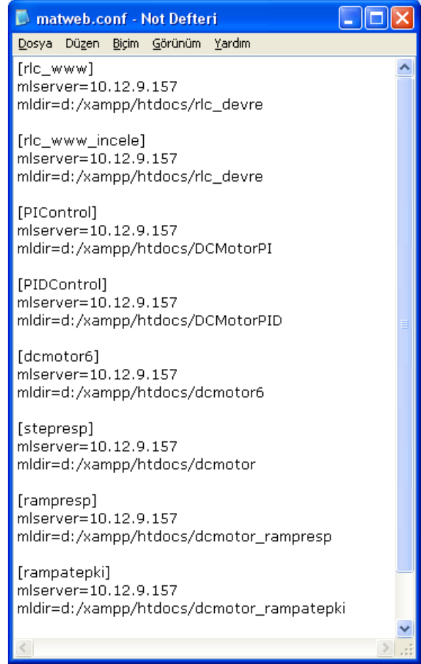
Şekil 8. matweb.conf ayar dosyasının görünümü (Screenshot of the matweb.conf configuration file)
