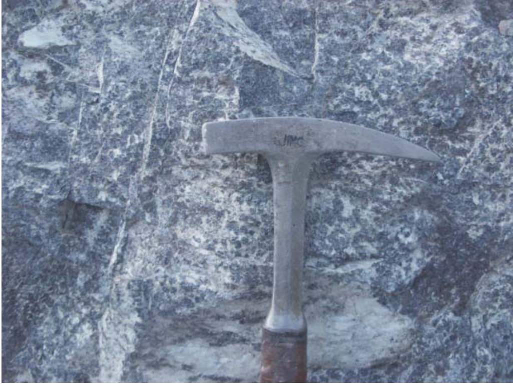
Şekil 4. Mehmetalan sahasında bulunan nodüler krom cevheri.
