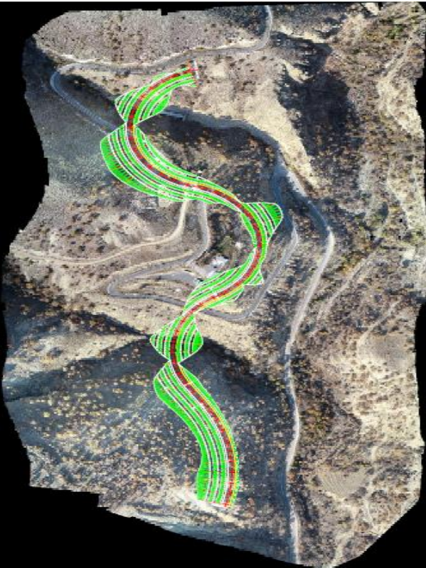
Şekil 15. Ortofoto ve karayolu güzergahı
