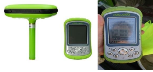
Şekil 4. Javad Triumph-1 GNSS cihazı
