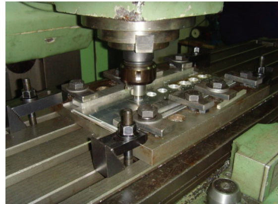
Şekil 2. Birleştirme yöntemi ve birleştirme sırasında deney numunelerini tutan kalıp (Friction stir spot welding method and the sample assembly mould)
