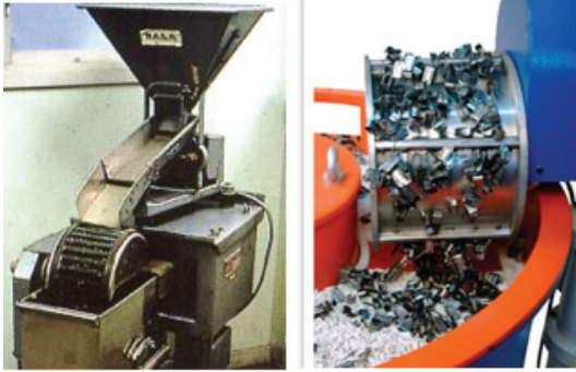
Şekil 8. Düşük alan şiddetli tambur tipi kuru manyetik ayırıcı tipleri.
