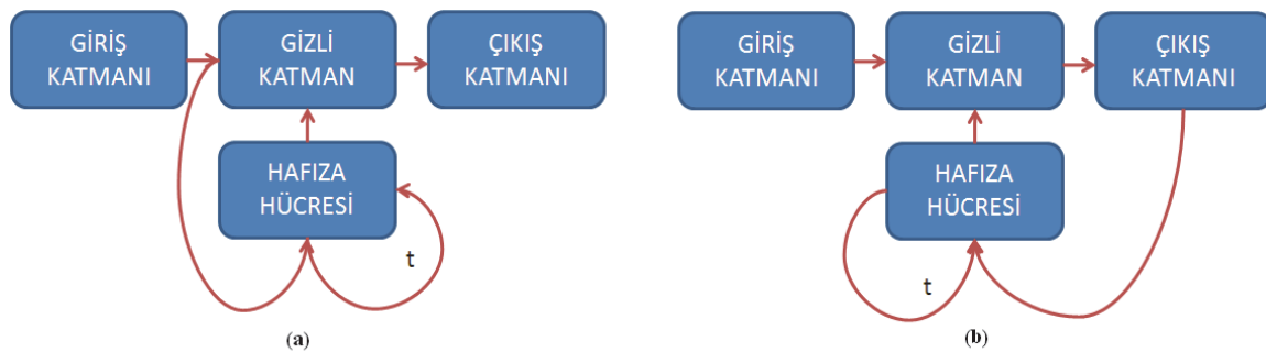
Şekil 1. (a)Elman Ağ Yapısı (b) Jordan Ağ yapısı ((a) Elman Network Structure (b) Jordan Network Structure)
