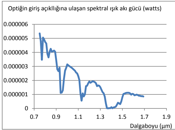
Şekil 4. Optiğin giriş açıklığına ulaşan spektral ışık gücü (Spectral light power reached to optical aperture entrance)
