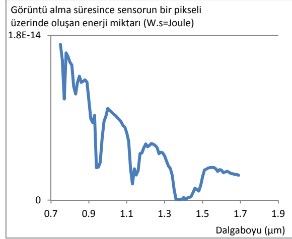
Şekil 6. Görüntü alma süresince sensörün bir pikseli üzerinde oluşan spektral enerji miktarı (Spectral energy generated per pixel during imaging)
