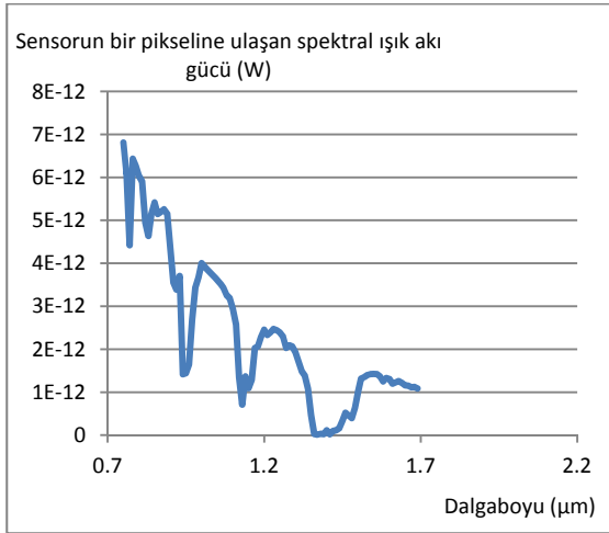
Şekil 5. Sensörün bir pikseline ulaşan spektral ışık akı gücü (Spectral light power intensity reached at sensor per pixel)
