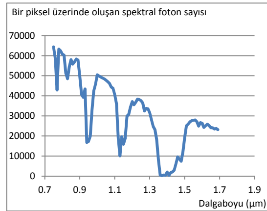
Şekil 7. Sensörün bir pikseli üzerinde oluşan foton sayısı (Number of photons generated over sensor per pixel)
