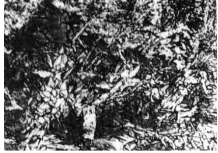
Şekil 3. Termomekanik işlem görmüş numunede kaynak metali mikroyapısı, (x 150)
