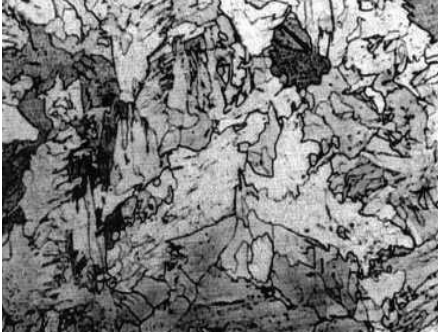
Şekil 4. (a) İşlem görmemiş (b) Termomekanik işlem görmüş numunelerde ITAB mikroyapısı, (x 150 )
