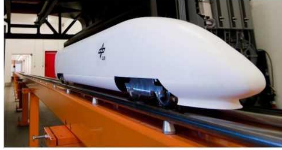
Şekil 3. Birmingham Üniversitesi'nin oluşturduğu 1:25 ölçekli hareketli test teçhizatı (solda), Alman Uzay Merkezi (DLR) 1:25 ölçekli yeni nesil tren (sağda)
