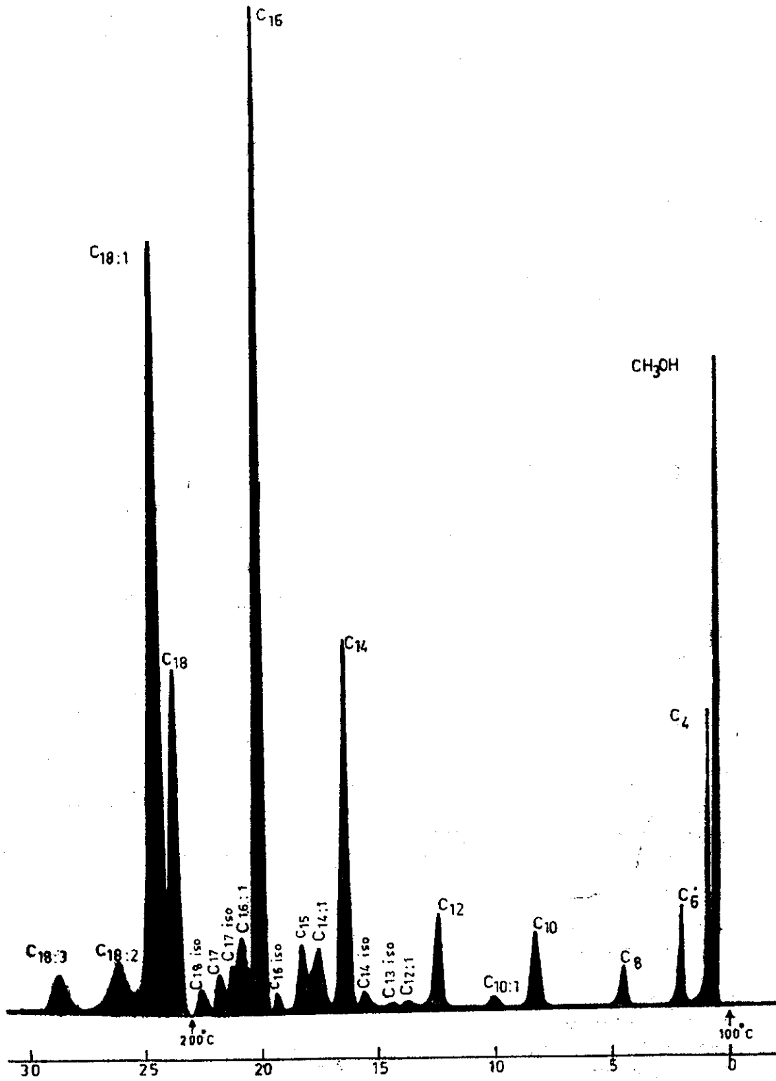
DAKİKA Kromatogram : 1 — Saf Tereyağında Tesbit Edilen Yağ Asiti Metil Esterleri
