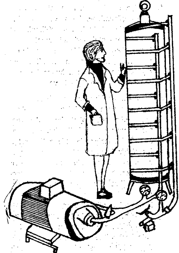
Şekil 1. Ultrafiltrasyon Ünitesi (Günde 8.700 l peynir suyu kapasiteli) (NIELSEN, et al., 1974)
