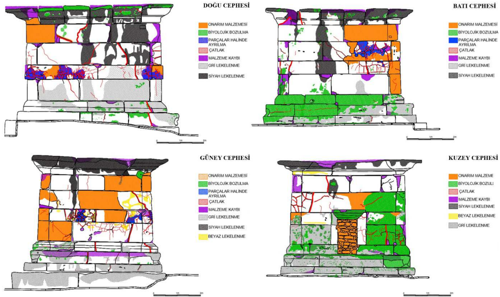
Fig. 7: Cephelerde görülen bozulma türleri ve onarım malzemeleri haritaları.
