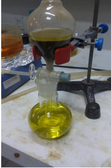
Şekil 2. Klasik ekstraksiyon ile karabaş otundan özüt eldesi aşamaları
