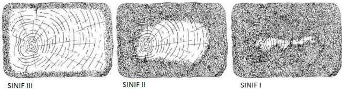
Fig. 2 Farklı sınıflardaki suya doymuş ahşapların kesit görünümü.
