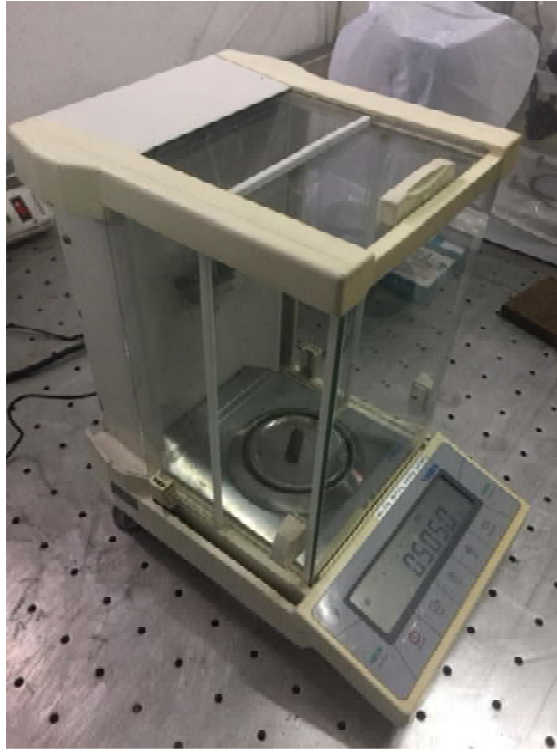
Fig. 4 Örneklerin kuru ağırlığının ölçülmesi.
