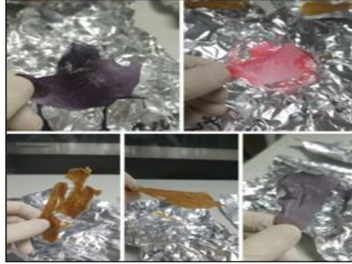
Şekil 5. Buğday ve mısır nişastasından elde edilen akıllı biyoplastik ve odun-biyoplastik kompozitlerinin 120 °C'de 45 dakika kurutma sonrası görüntüleri.
