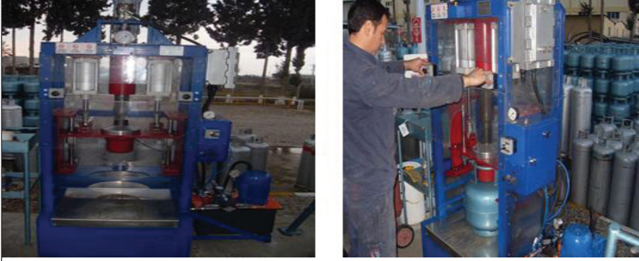
Şekil 11. a) Tekli Otomatik Gaz Aktarma Makinası b) Personel Makinayı Kullanırken
