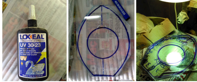
Resim 2. Camların UV yapıştırıcı ile yapıştırılması
