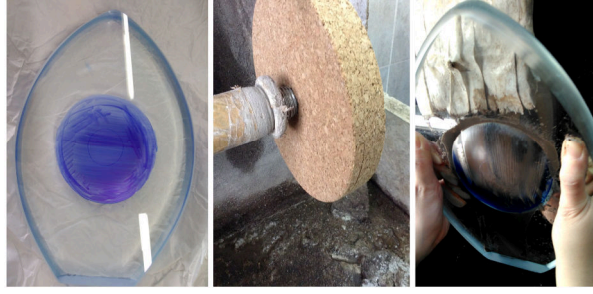
Resim 7. Parlatma işleminin mantar kafalarda gerçekleştirilmesi işlemi
