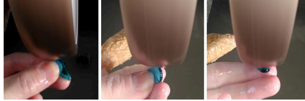
Resim 9. Kesilen füzyon camlarının 46 gritlik elmas taşında şekillendirilmesi
