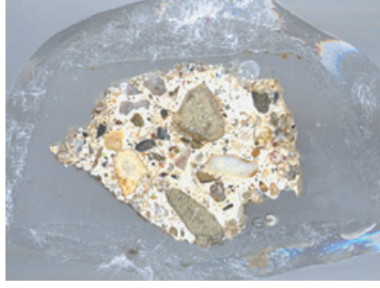
Şekil 10-11. Hamam olduğu düşünülen yapıda mermer levhaların sabitlenmesi için kullanılmış sıva tabakasından alınan ÇUY.15 no.lu örnek (sol), hidrolik özellik gösteren SAY.2 no.lu örneğin kesit dokusu (sağ)
