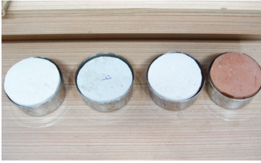
Resim 1. Buhar Geçirgenlik Direnci için hazırlanan kap ve numuneler.
