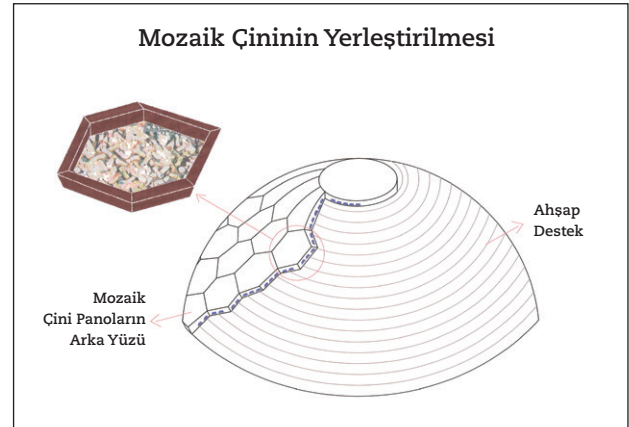
Cizim 5. Mozaik çininin yerine yerleştirilmesi
