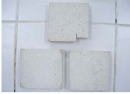
Sekil 7. %2 K 2 SO 4 çözeltisinde ıslanma-kuruma çevrimlerinde 15. çevrimden sonraki resim, sağda uygulama yapılmış yüzey, solda uygulama yapılmamış yüzey (I.2.)
