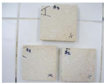
Sekil 10. Uygulama yapılmamış taş yüzeylerinin %3 H 2 SO 4 çözeltisinde ıslanma-kuruma çevrimlerinden 15. çevrim sonundaki resmi (I.3.)
