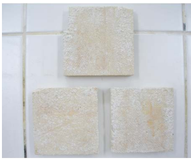
Sekil 9. Uygulama yapılmış taş yüzeylerinin %3 H 2 SO 4 çözeltisinde ıslanma-kuruma çevrimlerinden 15. çevrim sonundaki resmi (I.3.)
