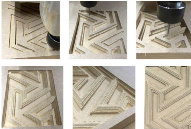
Görsel 6: Amasya Darüüşşifası portalinden 1 numaralı desene ait CNC deneme üretimi (ahşap) Üst sıra üç aşamalı denemeyi, alt sıra sonuç örneğini gösteriyor. (Hamzaoğlu ve Özkar 2018)
