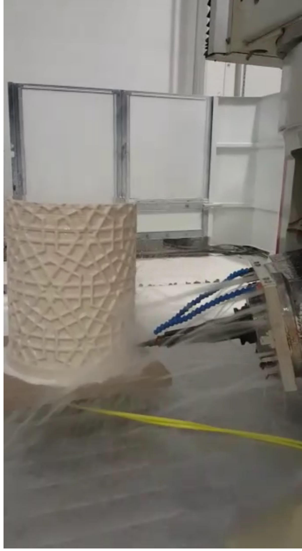
Görsel 11: Mama Hatun Türbesi'nden bir desenin CNC ile silindir taş üzerine uygulaması (Görsel: C. Tolunay )
