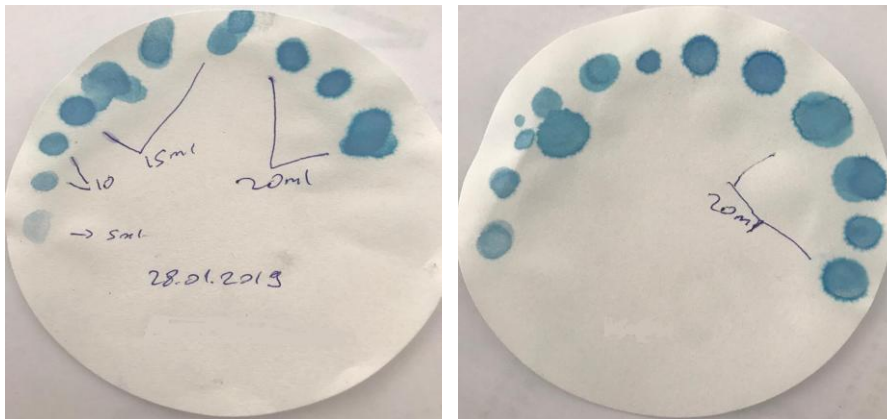
Şekil 4. Metilen mavisi deneyinde hale oluşumu.
