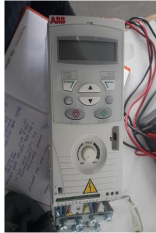
Şekil 4. Kullanılan ABB ac sürücü 0.37 kW
