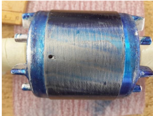
Şekil 7. Tek rotor çubuk hasarı (Delik çapı 2mm)
