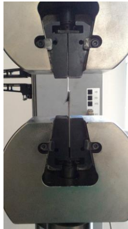
Şekil 8: Kesme testi uygulaması
