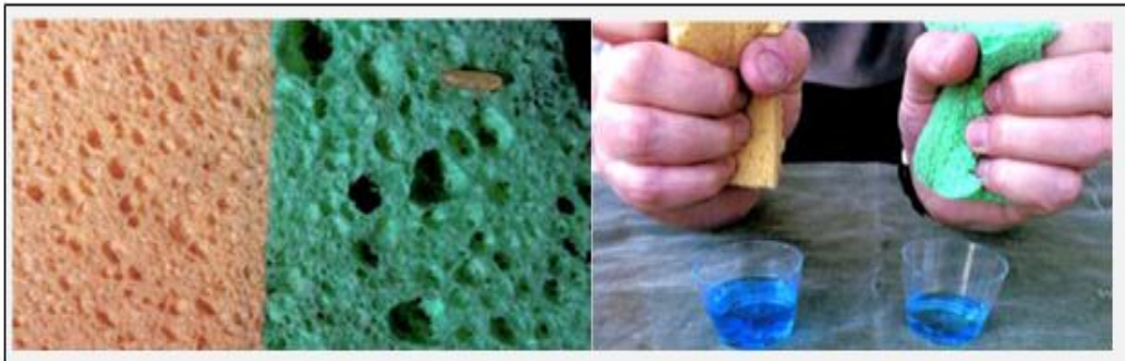
Şekil 6. Gözenek büyüklüğünün su içeriğine etkisi (Anonyomus 1998) Figure 6. Effect of pore size on water content.
