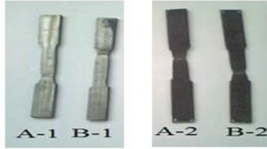
Şekil 3. Çekme denemesinde kullanılan bazı uç demiri örnekleri. Figure 3. Some shares samples used in pulling test
