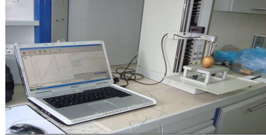
Şekil 2. Patatesin puncture (delme) testinden bir örnek
