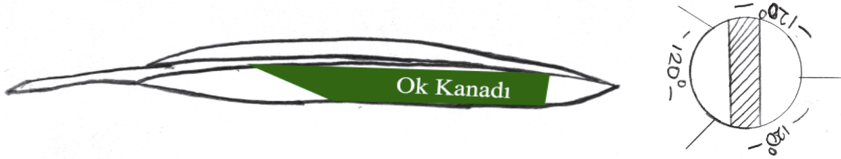
Resim 12. Tüy Kanatların kesilme alanı ve ok gövdesine yapıştırma şekli.
