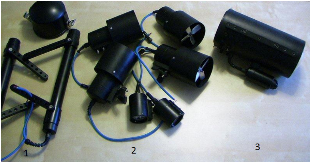
Şekil 2. Gövde kazağı (1), motorlar ve aydınlatmalar (2), ana gövde ve basınç sensörü (3)
