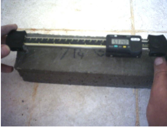
Şekil 2. Multi-position strain gauge cihazı ile rötre ölçümlerinin yapılması
