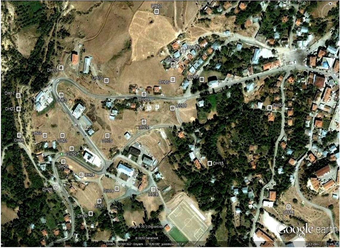
Şekil 2. Emniyet binası civarındaki 50 m aralıklarla tesis edilen GPS noktaları
